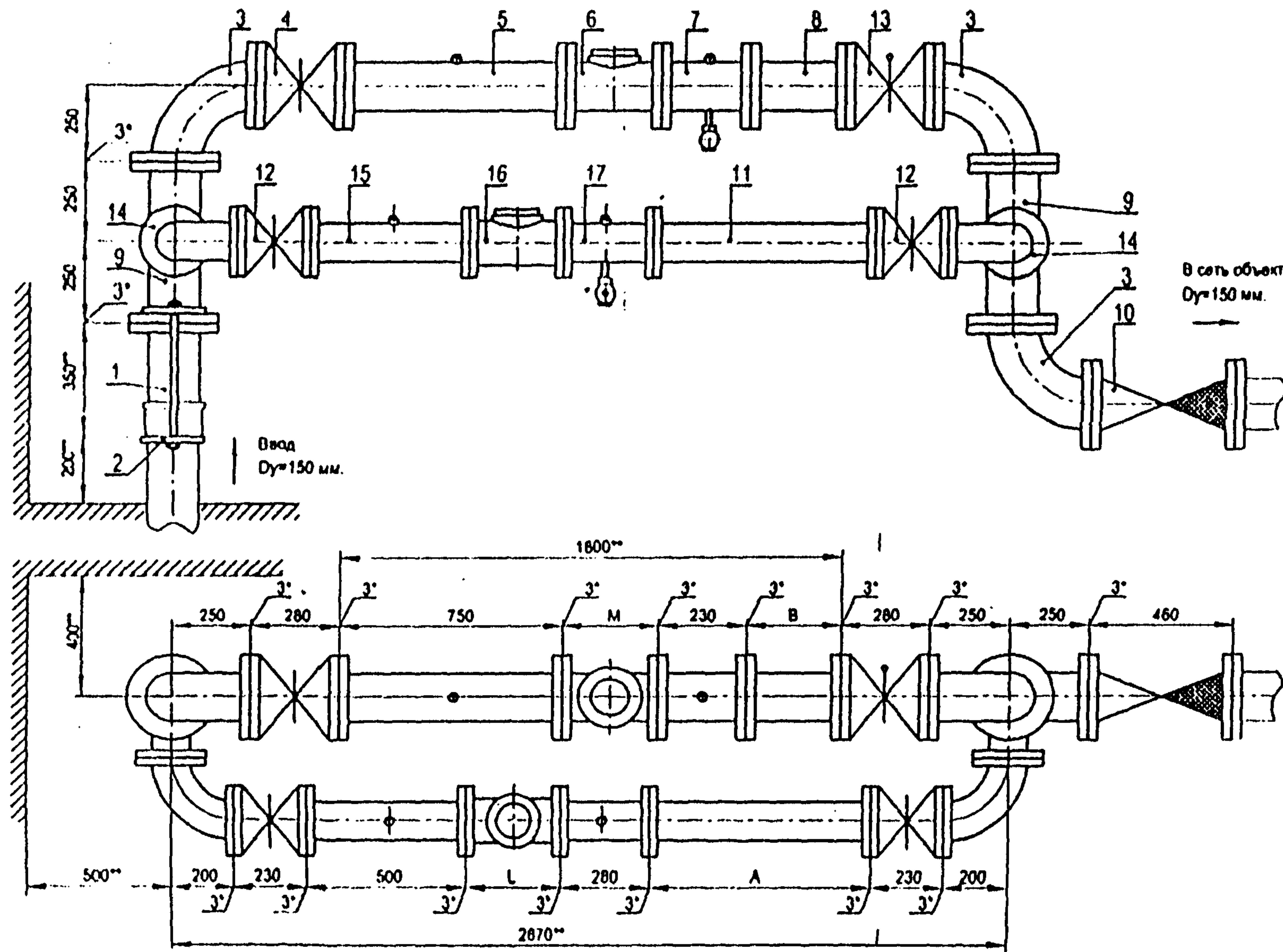
Установка счетчика  $Dv=100$  мм на хозяйствственно-питьевой линии и счетчика  $Dv=150$  мм на пожарно-разъездной линии в водометном узле на воде диаметром 150 мм.
